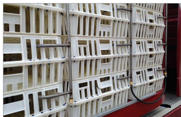
Sistema para la provisión de agua durante el transporte.
